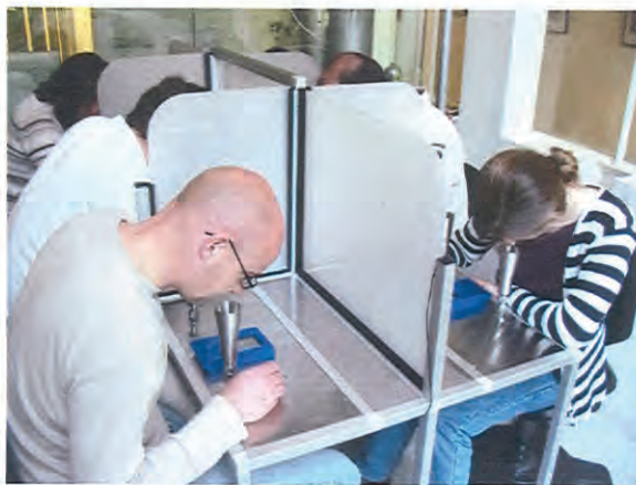
Figuur b: Het uitvoeren van geuranalyses in het laboratorium van PRA Odournet bv
