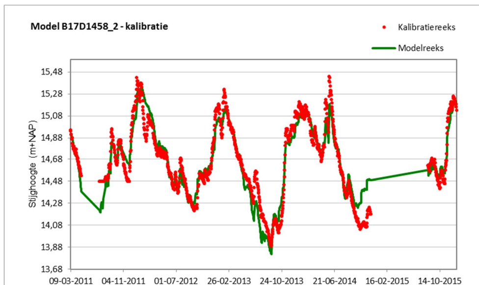
Figuur 6-7 Gemeten en gemodelleerde stijghoogten B17D1458_2 lineair model
