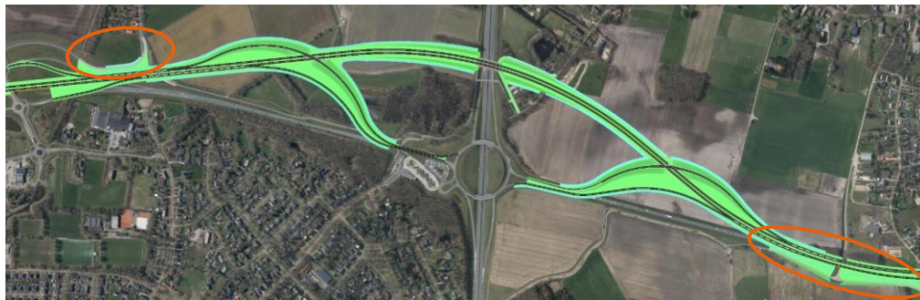
Figuur 4-3: Luchtfoto met ontwerp wegvak 2 verschoven fly-over
