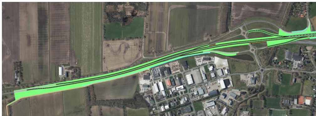
Figuur 4-2: Luchtfoto met ontwerp wegvak 1 verschoven fly-over
