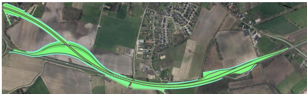
Figuur 4-4: Luchtfoto met ontwerp wegvak 3 verschoven fly-over
