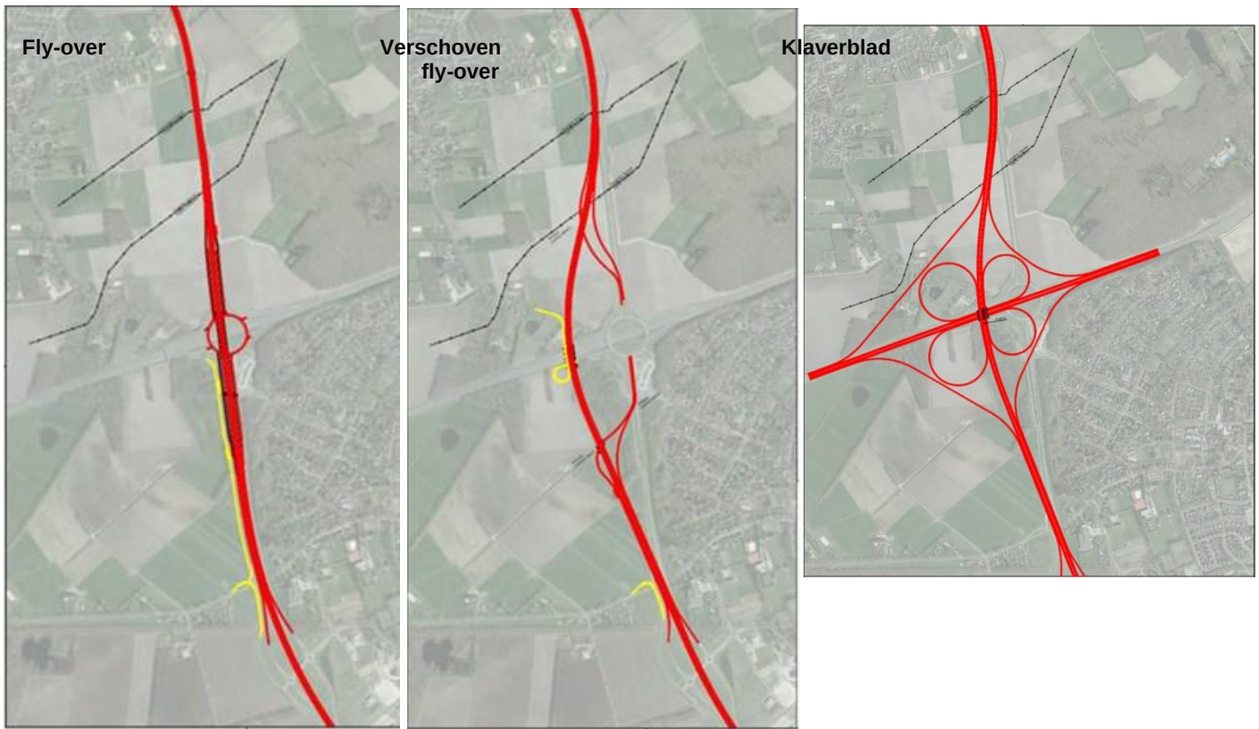
Figuur 3-2 Oplossingen aanpak verkeersplein Gieten: Fly-over, Verschoven fly-over en Klaverblad
