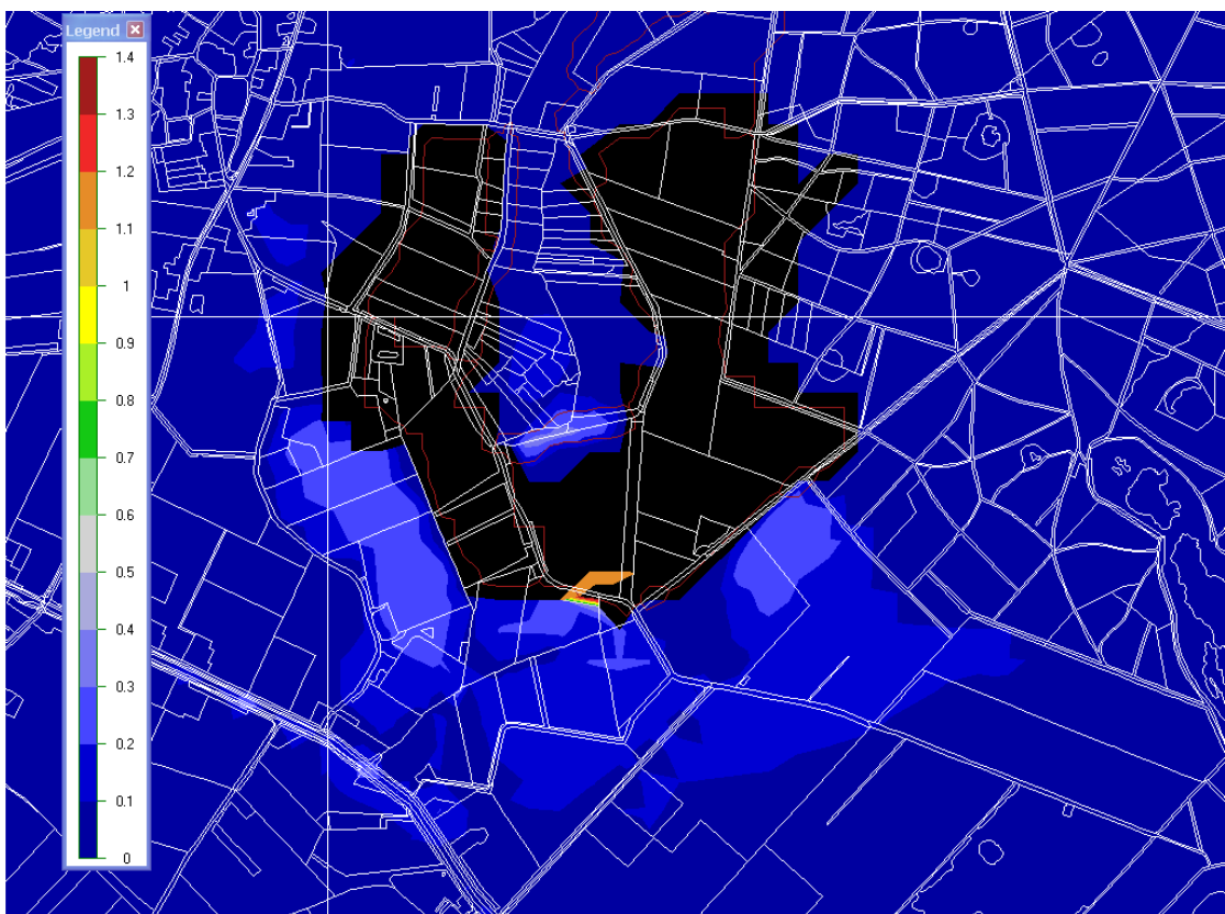
Effect scenario B+C+D: toename diepe kwel (h5-> h4) (mm/dag) ingezoomd voor Reitma.
