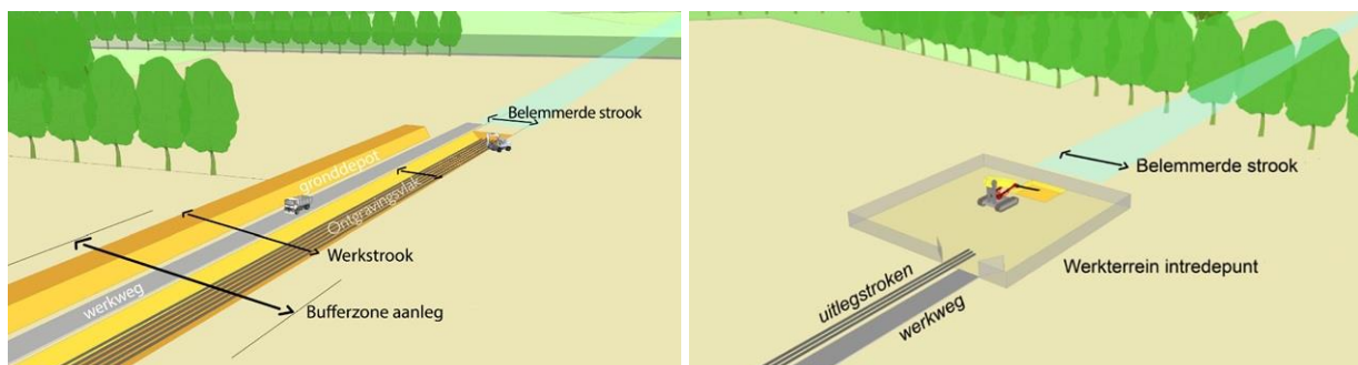
Figuur 4.1 | Visualisatie van een open ontgraving (links) en gestuurde boring (rechts)
