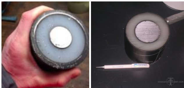
Figuur 8.1 | Voorbeeld een 150 kV-kabel (links 15 ) en 110 kV-kabel (rechts 16 ).
