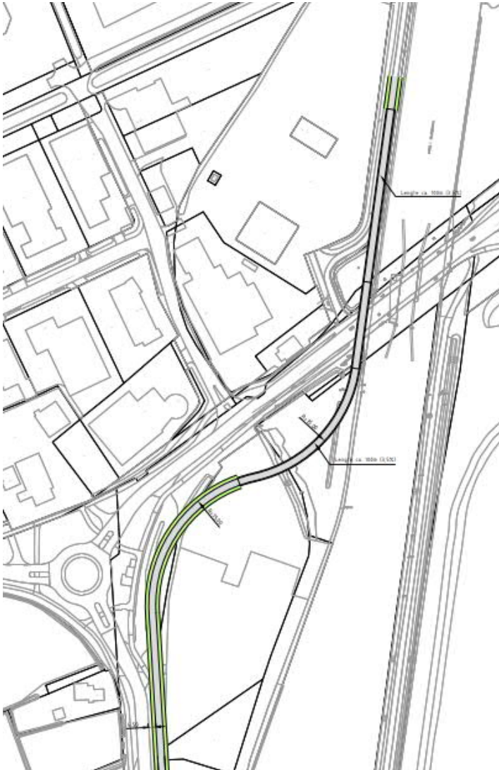
Figuur 3.7: Mogelijke tunnel Groningerstraat (bron: provincie Drenthe)
