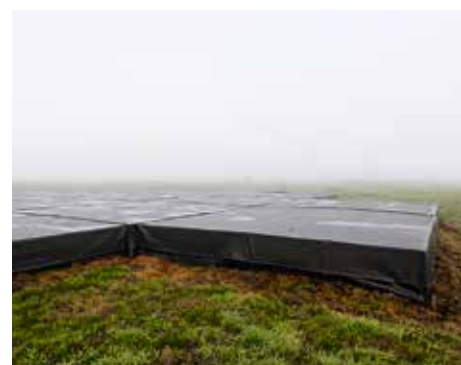
Bij Buinen staan twee typen telescopen. 48 zwarte dozen (voor hoge frequenties) en 96 'buitenantennes' – witte vlaggenmasten willekeurig in het grasland geplaatst.
