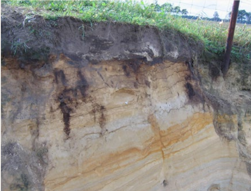
Dekzandlaag van het profiel
