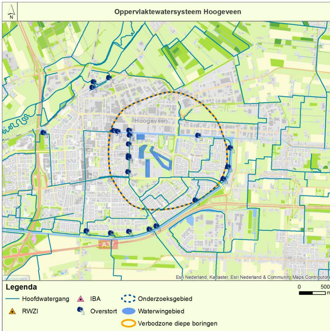
Figuur 6-4 Oppervlaktewatersysteem Hoogeveen
