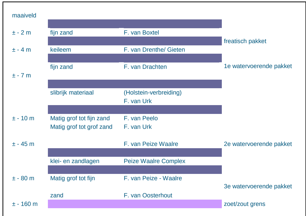
Figuur 4-1 Schematische weergave van de ondergrond ter plaatse van de grondwaterwinning
